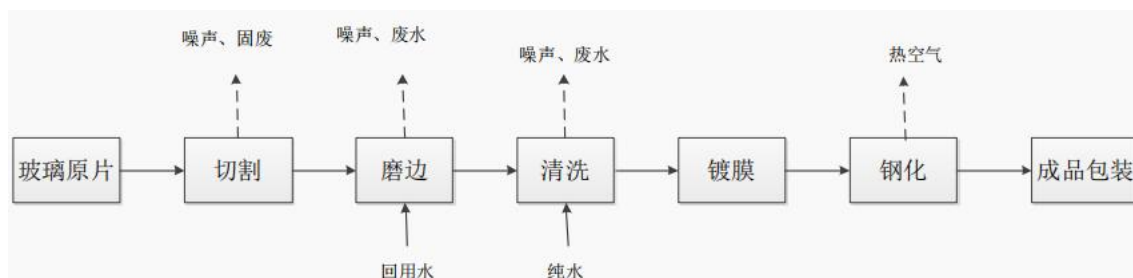
图 1-3 汽车镀膜玻璃加工工艺流程图
